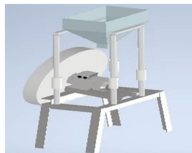
1-rasm. Don maydalagichning texnologik va 3-D sxemasi: 1-Ishlab chiqilgan qurilma don bunkeri, 2-me'yorlash novi, 3-maydalash kamerasi, 4-rekatterlar, 5-bolg'achali propeller, 6-maydalangan donli ozuqa chiqish novi.
