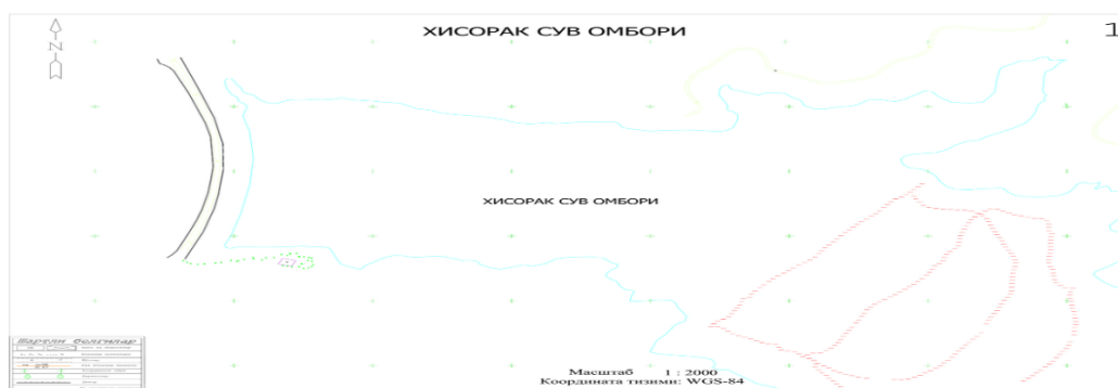
2-rasm. Hisorak suv ombori topografik-kadastr rejasining 1-varag'i (masshtab 1:2000, WGS-84): suv ombori chegarasi, yondosh avtomobil yo'li, daraxtzor va yer uchastkasi konturi
