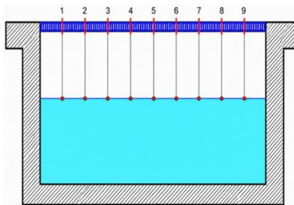
b) kanal ko'ndalang kesimida to'qqizta o'lchash vertikalining joylashuvi
