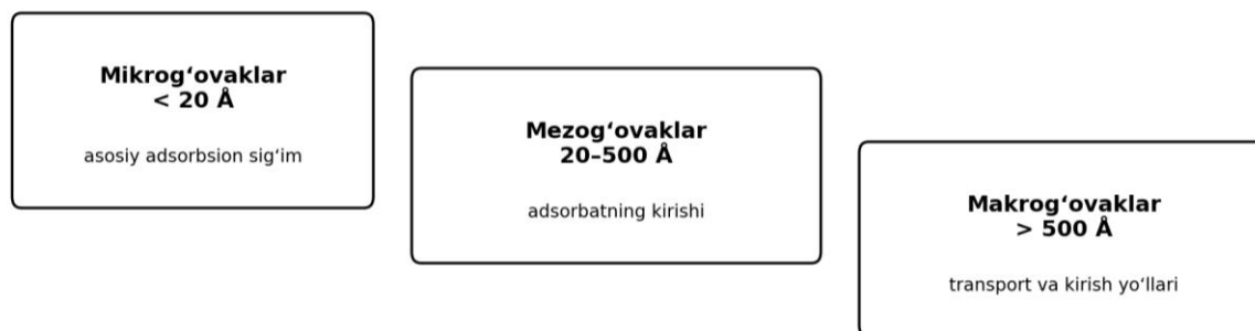
3-rasm. Faollashtirilgan ko‘mir g‘ovaklarining funksional tasnifi.
