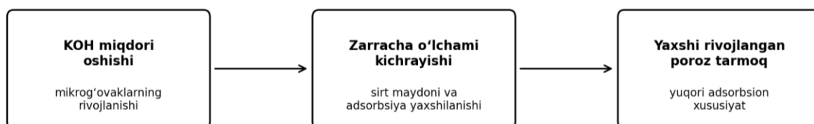
2-rasm. KOH miqdori va zarracha o‘lchamining adsorbsion xususiyatlarga ta‘sirini umumlashtiruvchi konseptual sxema.
