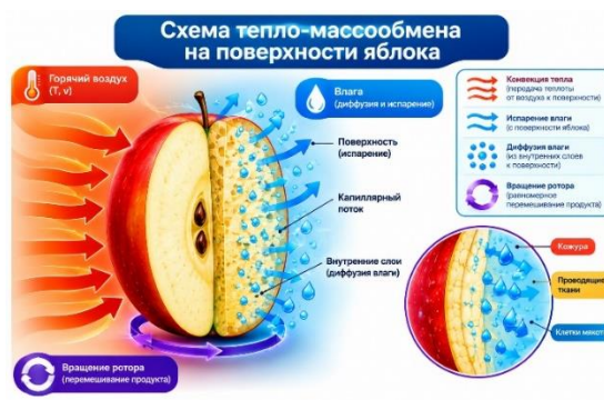
Рис 1. Схема тепло-массообмена на поверхности яблока.
