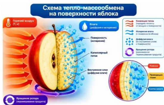
Рис 1. Схема тепло-массообмена на поверхности яблока.
